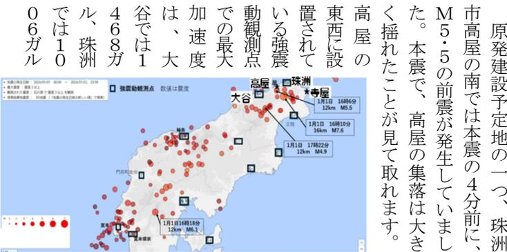
です。いずれも震度で言えば、6強となります。また、珠洲市の若山川沿いの断層に沿う崖の出現が目されましたが、ここでも一時間後に余震が頻発していました。若山川沿いの地震は、地表に活断層として現れていなくても、地下では地震を起こしている断層があり、能登半島地震で数Kmに渡って地震断層として現れるとともに、最大4mの段差を伴う崖が、生じました。高屋の海岸は2mに達する隆起が生じました。また、高屋の予定地の裏山では、激しい震動に伴って、大規模な崖崩れが発生し、巨大な岩塊を含む土石の崩落が起こっています。
